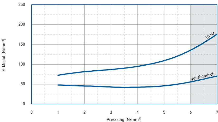
Dynamische Prüfung: harmonische Anregung mit einer Amplitude von  $\pm 0,11 \text{ mm}$  bei 10 Hz
