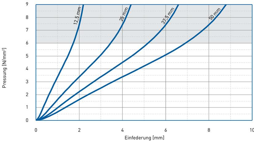
Aufgezeichnet wurde jeweils die 3. Belastung, Prüfung bei Raumtemperatur zwischen ebenen Stahlplatten mit Schleifleinen der Körnung K 120.
