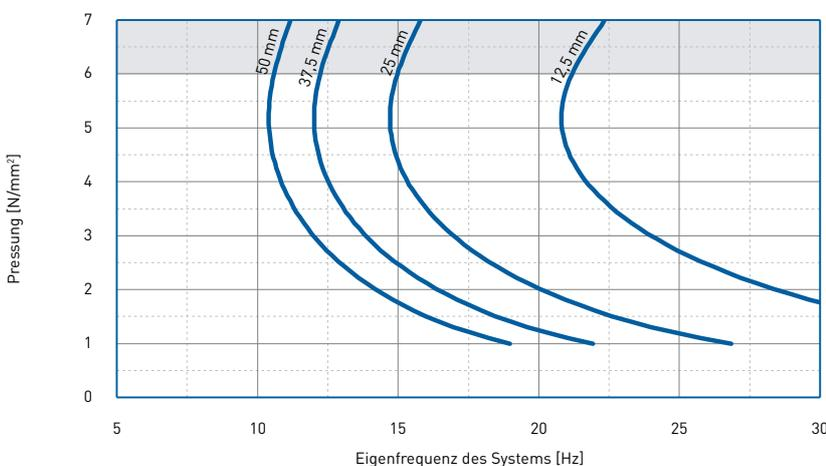
Eigenfrequenz eines Systems, bestehend aus einer kompakten Masse und einer elastischen Lagerung aus PURASYS **vibradyn** HL 6000 auf starrem Untergrund.
