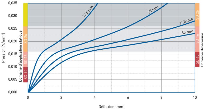
Contrôle entre des plaques d'acier plates et parallèles, enregistrement au 3<sup>ème</sup> cycle, contrôle à température ambiante.
