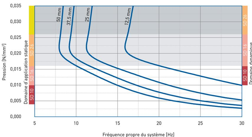
Fréquences propres d'un système vibratoire à un degré de liberté, comprenant une masse rigide et un appui élastique en PURASYS **vibrafoam** SD 16 sur structure rigide.
