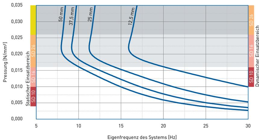
Eigenfrequenz eines Systems, bestehend aus einer kompakten Masse und einer elastischen Lagerung aus PURASYS **vibrafoam** SD 16 auf starrem Untergrund.
