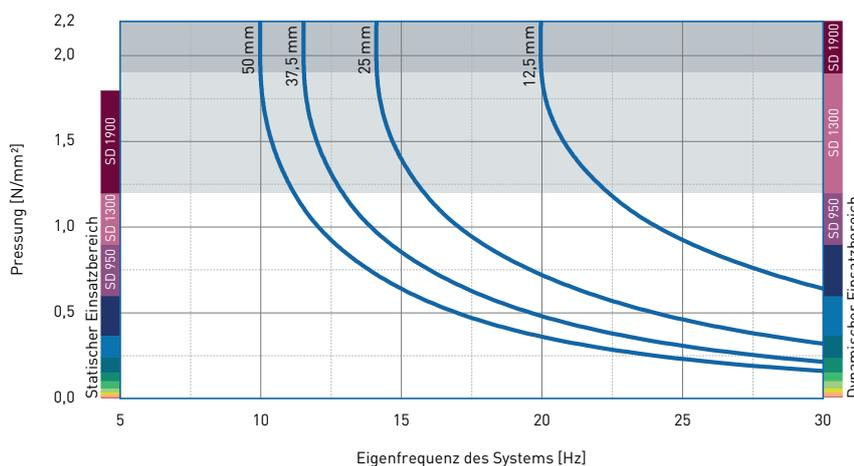
Eigenfrequenz eines Systems, bestehend aus einer kompakten Masse und einer elastischen Lagerung aus PURASYS **vibrafoam** SD 1300 auf starrem Untergrund.
